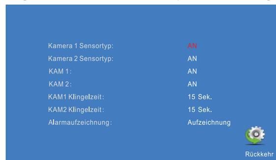
**Kam1/Kam2 Sensortyp** Jeder Kamerakanal entspricht dem E/A-Modus, d. h., wenn ein Alarm aktiviert wird, wird auch der entsprechende Kanal für die Aufzeichnung oder Aufnahme von Bildern aktiviert.
