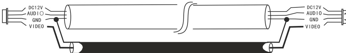
3. Standardkabel mit integriertem Koaxialkabel für das Videosignal (2x0,5mm<sup>2</sup> + 75-3). Der Bildschirm sollte mit GND verbunden werden.
