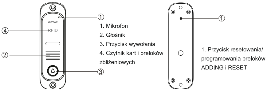
rys. 1 Budowa panelu zewnętrznego
