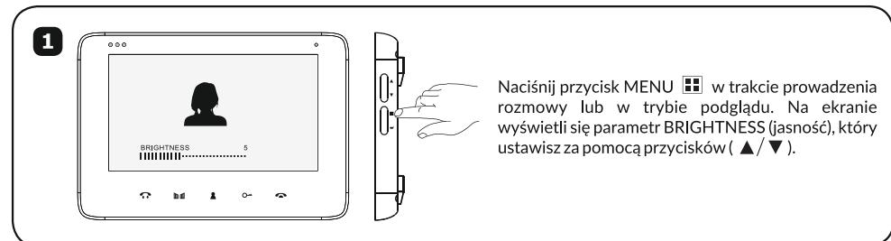
Naciśnij przycisk MENU w trakcie prowadzenia rozmowy lub w trybie podglądu. Na ekranie wyświetli się parametr BRIGHTNESS (jasność), który ustawisz za pomocą przycisków ( $\Delta$ / $\nabla$ ).
