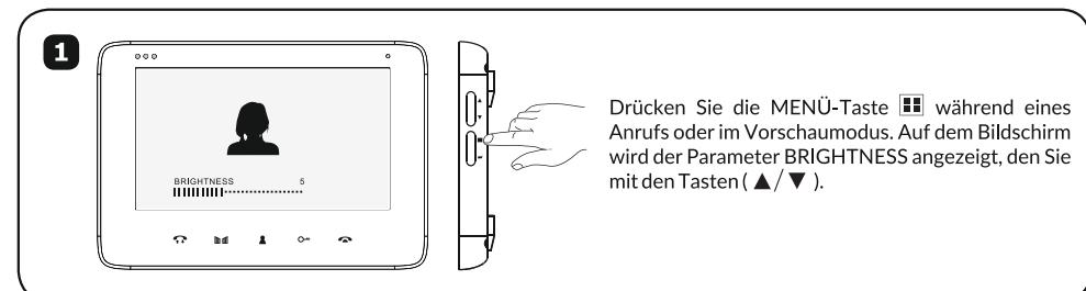
Drücken Sie die MENÜ-Taste während eines Anrufs oder im Vorschaumodus. Auf dem Bildschirm wird der Parameter BRIGHTNESS angezeigt, den Sie mit den Tasten (▲/▼) einstellen.
