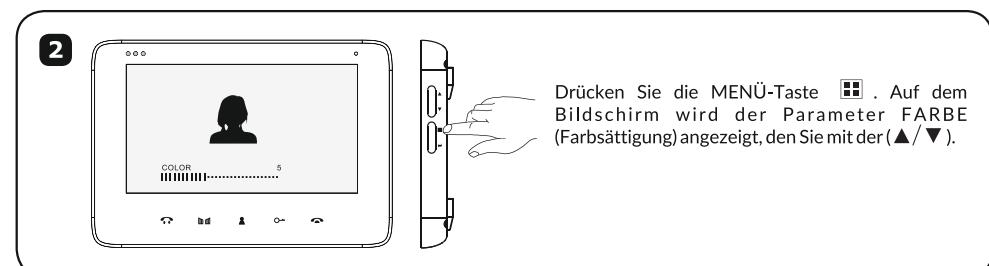
Drücken Sie die MENÜ-Taste . Auf dem Bildschirm wird der Parameter FARBE (Farbsättigung) angezeigt, den Sie mit den Tasten (▲/▼) einstellen.
