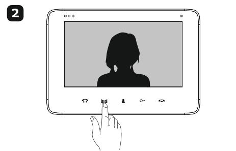
Aby otworzyć bramę zewnętrzną, naciśnij przycisk STEROWANIE BRAMA.
