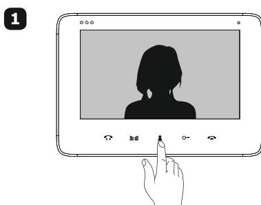
Um das Kamerabild in der Vorschau anzuzeigen, drücken Sie die ÜBERWACHUNG-Taste. Drücken Sie die gleiche Taste erneut, um in den Standby-Modus zurückzukehren.
