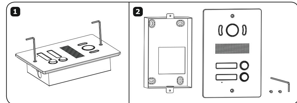
3. Odkręć cztery śruby umieszczone z tyłu kasy.
