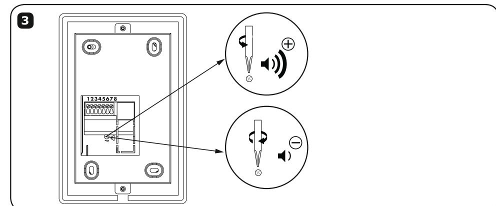
4. Podłącz przewody zgodnie ze schematem podłączania (patrz punkt 5) i ustaw poziom głośności dla kasy zewnętrznej.
