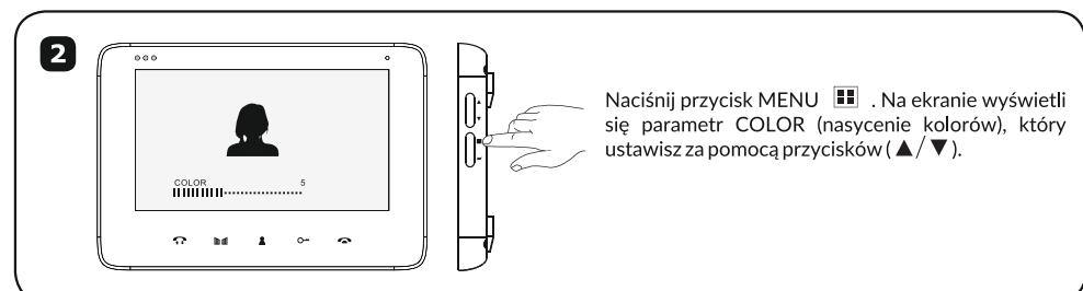
Naciśnij przycisk MENU . Na ekranie wyświetli się parametr COLOR (nasycenie kolorów), który ustawisz za pomocą przycisków ( $\Delta$ / $\nabla$ ).
