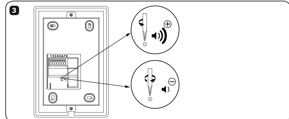
4. Schließen Sie die Drähte gemäß dem Schaltplan (siehe Punkt 5) an und stellen Sie den Lautstärkepegel für die Außenkassette ein.
