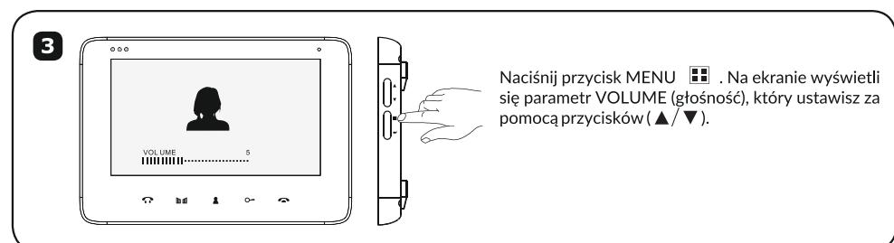
Naciśnij przycisk MENU . Na ekranie wyświetli się parametr VOLUME (głośność), który ustawisz za pomocą przycisków ( $\Delta$ / $\nabla$ ).
