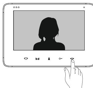
W celu rozpoczęcia rozmowy z osobą stojącą na zewnątrz naciśnij przycisk ROZMOWA. Naciśnij ten sam przycisk ponownie, aby wyłączyć panel monitora.
