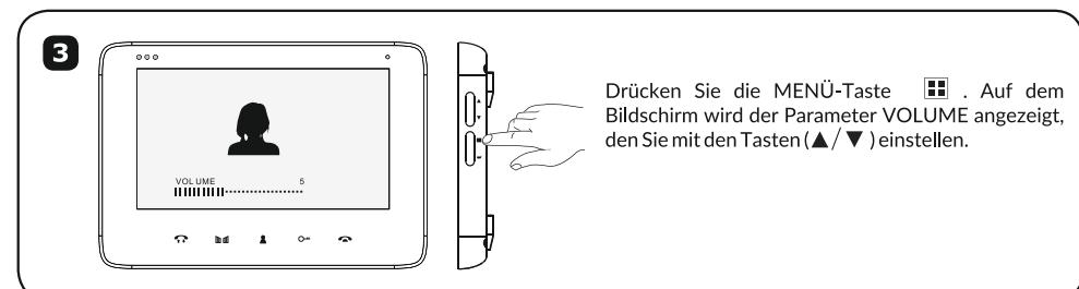
Drücken Sie die MENÜ-Taste . Auf dem Bildschirm wird der Parameter VOLUME angezeigt, den Sie mit den Tasten (▲/▼) einstellen.
