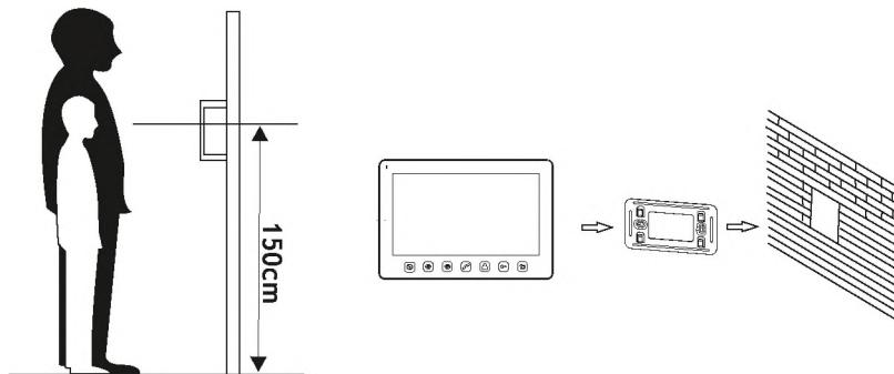
Preporučuje se testirati rad uređaja prije bušenja rupa za montažu. U tu svrhu spojite uređaj prema shemi ožičenja. Nakon temeljite provjere, nastavite s bušenjem rupa za montažu nakon isključivanja napajanja.
