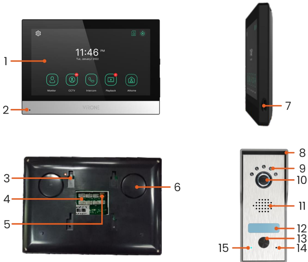
Abb. 1 Aufbau des Monitors und der Außenstation mit Kamera
